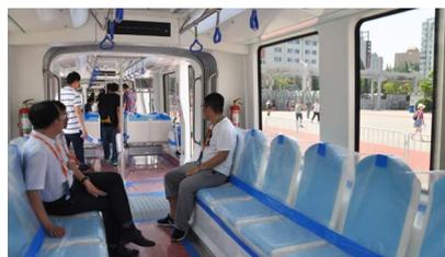
■ 100% 低地板现代有轨电车。该有轨电车可以通过供电网、蓄电池、地面供电方式为车辆提供驱动电力，生命周期大约在 30 年左右，目前已在珠海正式运行。其时速可以达到每小时 70 公里，满载可以乘坐 300 人，空间非常宽敞。在遇到客流高峰的时候，列车可以通过加挂车厢增加运力。
