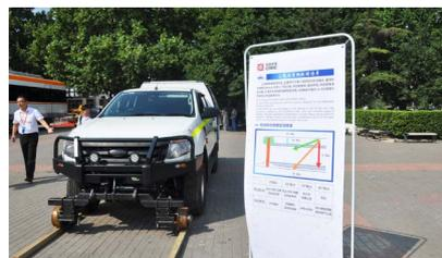
■ 公铁两用车，主要用于轨道牵引、调车作业，也可用于轨道货物转运和不落轮镟床的配套设备。
