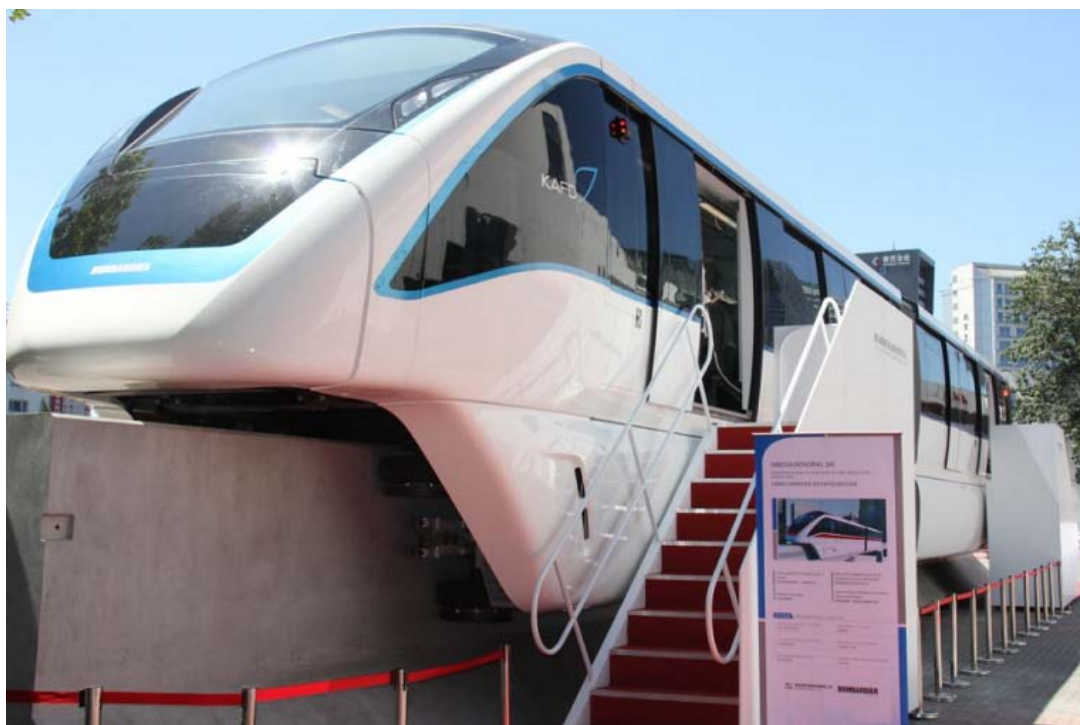
▲南车浦镇庞巴迪运输系统有限公司的 INNOVIA MONORAIL 300 单轨系统
